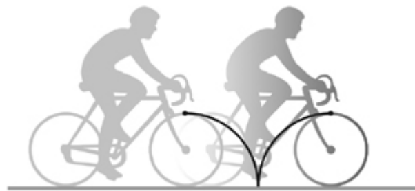
Bicicleta em movimento e a cicloide em evidência.
