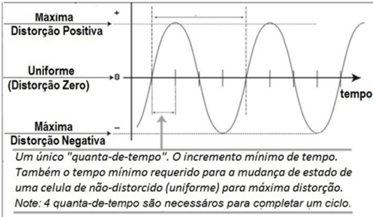
***Figura 1.3: Oscilação bipolar na forma de seno( $\omega t$ )***
