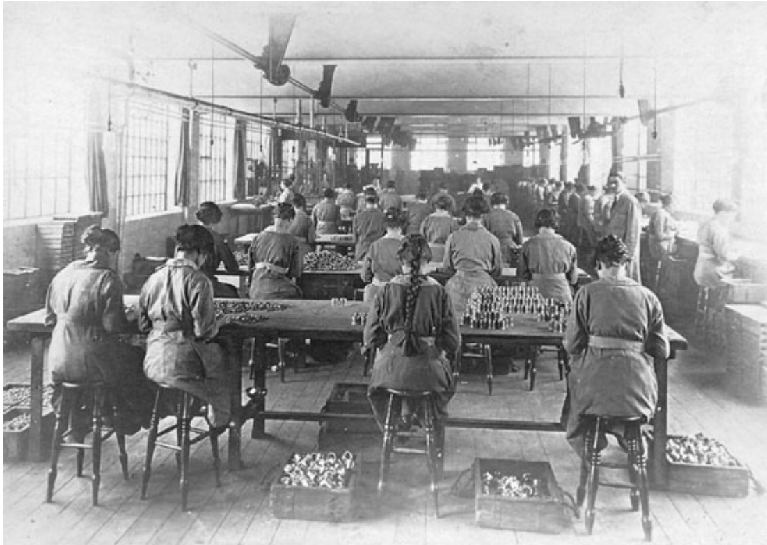
8. O ciclo de vida de um projétil, parte 1. "Departamento de Medição nº 2": mulheres fabricando câmaras de disparo para granadas de fuzil na Suckling Ltd., parte da Kingsway House War Productions. Observe-se que o contramestre é um homem.
