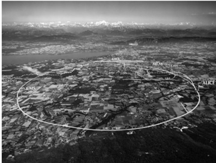
Laboratórios de física para o estudo de partículas elementares da matéria, em 1926 e hoje (a posição do túnel do acelerador de partículas, de 27 quilômetros de circunferência e alguns metros abaixo do solo, é indicada pelo círculo branco).
