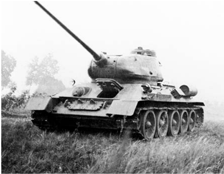
27. A versão avançada do tanque T-34-85 dispunha de uma torre de combate maior e de uma arma mais poderosa, que havia sofrido grandes alterações em relação ao do protótipo inicial.
