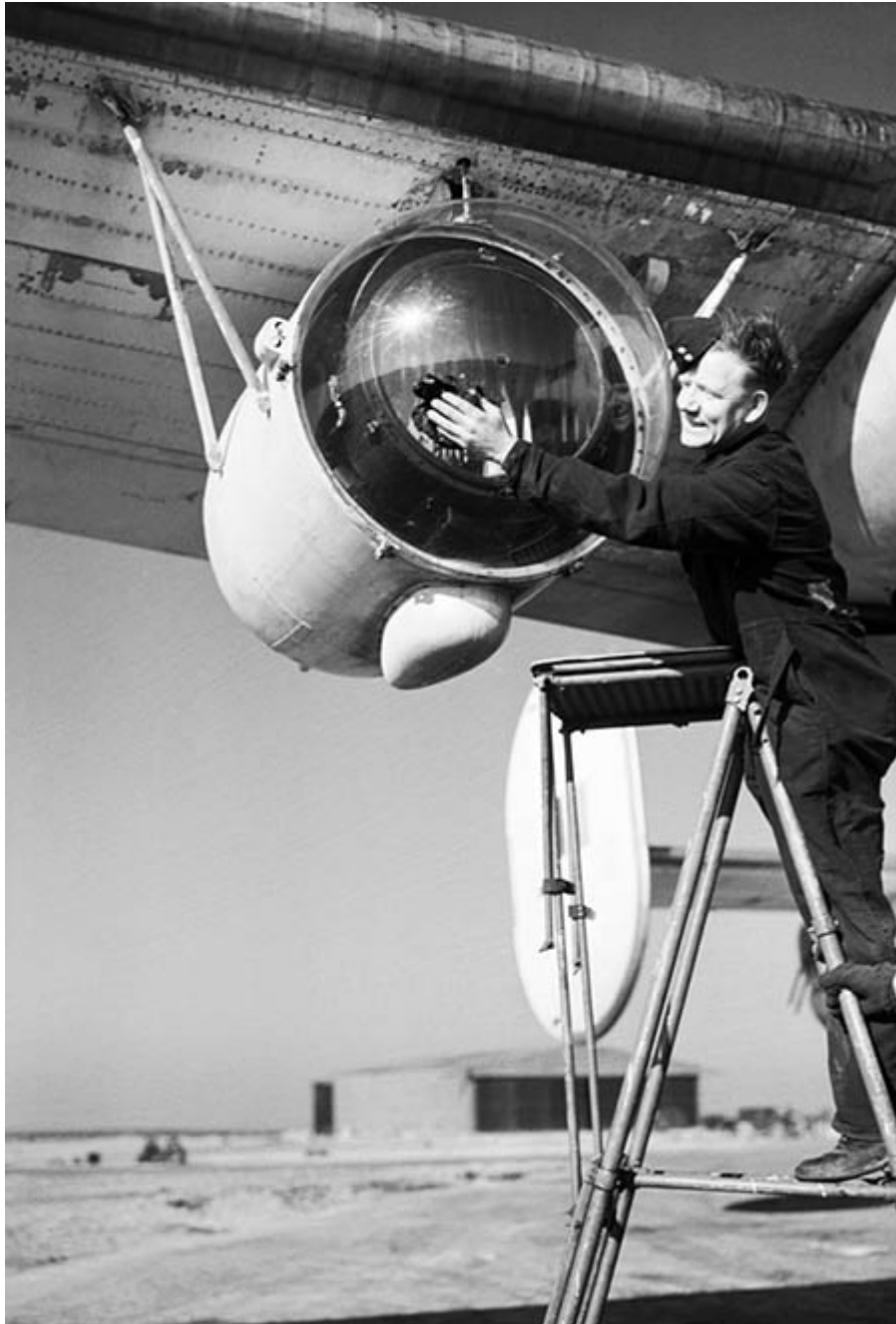
18. As Leigh Light, utilizadas para a localização noturna de submarinos inimigos na superfície da água. Aqui o dispositivo está sendo instalado num avião do Comando Costeiro da RAF, a Força Aérea Real britânica.
