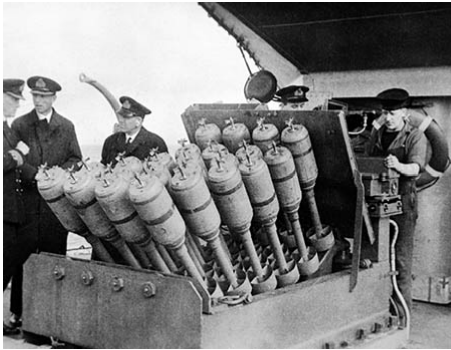
15. O morteiro Hedgehog, arma com 24 cilindros explosivos, instalado na parte dianteira do navio de escolta britânico Westcott .
