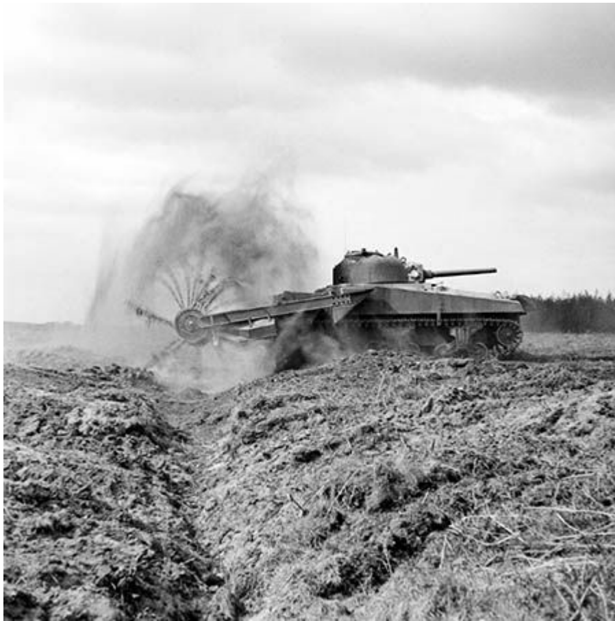
39. Um dos tanques Flail de Hobart em ação. Esses tanques tinham a função de "debulhadores" de terrenos minados. Nesta imagem, a posição da torre de combate foi temporariamente invertida; os tanques estão operando para a frente.
