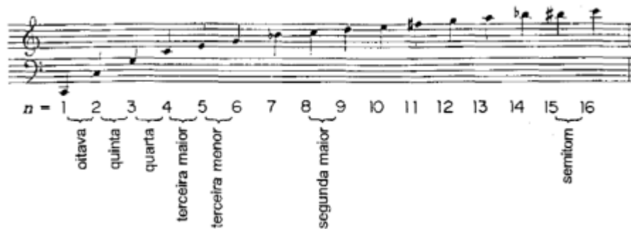
Figura 51. A série de harmônicos ou sobretons emitidos por uma corda vibrando. Os números indicam as frequências relativas das notas.
