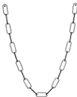
Figura 62. A catenária: a curva de uma corrente suspensa.
