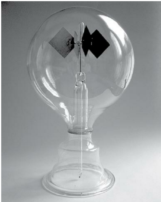
Radiômetro de Crookes – a ventoinha com quatro pás gira quando a luz a ilumina
