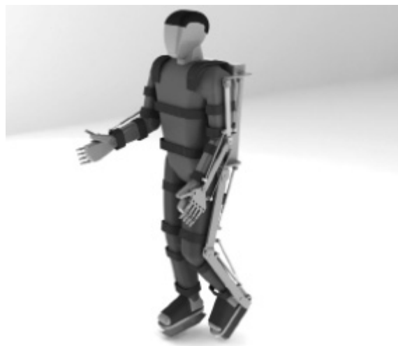
Figura 13.2 — Ilustração do exoesqueleto de corpo inteiro a ser utilizado pelo projeto Andar de Novo. (Cortesia do dr. Gordon Cheng, Universidade Técnica de Munique.) Ver encarte colorido.
