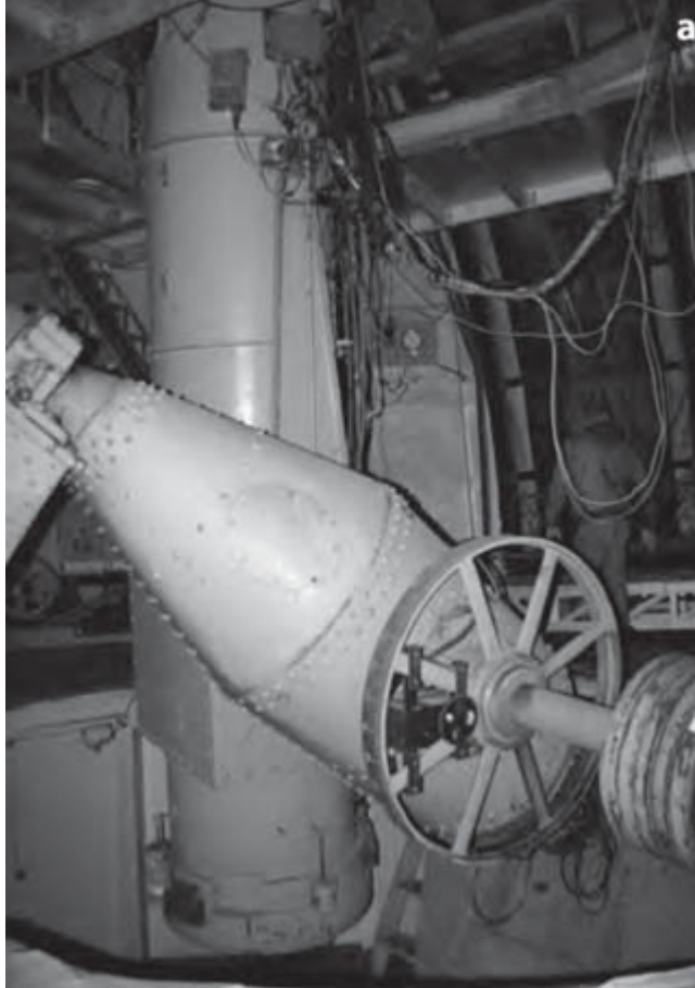
a. O telescópio Crossley do Observatório Lick contém um espelho de 36 polegadas no fundo e um espelho secundário no alto do tubo, que, juntos, refletem a luz focada em um óculo ou espectroscópio no lado do tubo. Com esse instrumento, James Keeler foi capaz de observar milhares de nebulosas. FOTO DO AUTOR.
